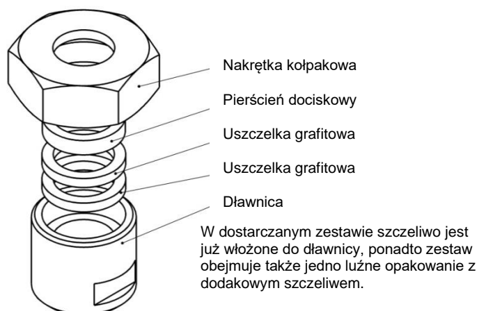
Rysunek 12: Budowa uszczelnienia dławnicowego
